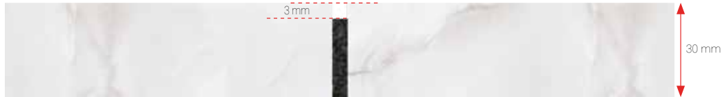
PFLASTER OHNE PHASE
